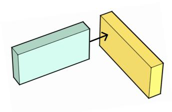
Tipp: Für Eckverbindungen sind stumpfe Holzverbindungen weniger günstig, da hier Stirnholz auf Längsholz trifft und somit allein durchs Verleimen keine so stabile Verbindung entsteht. Wir empfehlen hier eine zusätzliche Verstärkung durch Dübel oder Schrauben.
